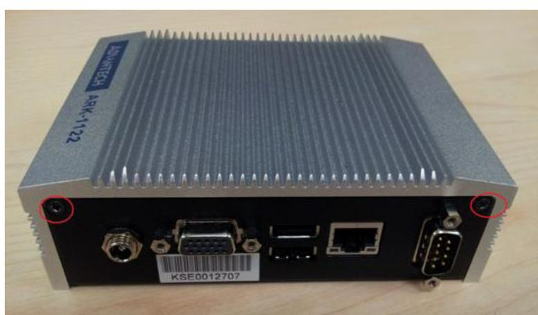
4. 移除铝制机箱顶盖并安装 RAM。
