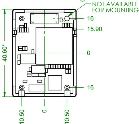
TOLERANCE  $\pm .127\text{mm}$
