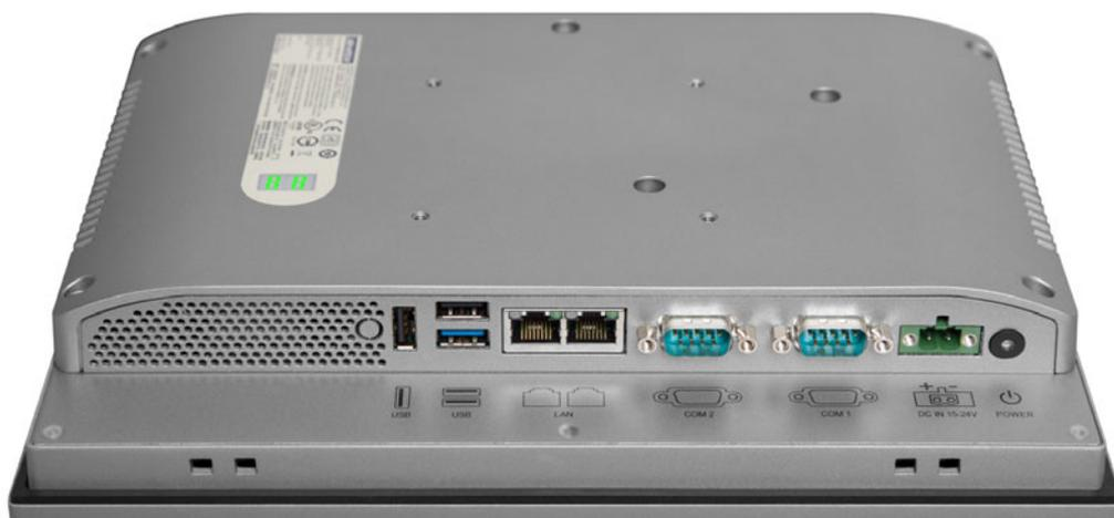
图 1.3: PPC-3100S/3120S/3150S 底部接口（除 PPC-3100S-PBE 外）
