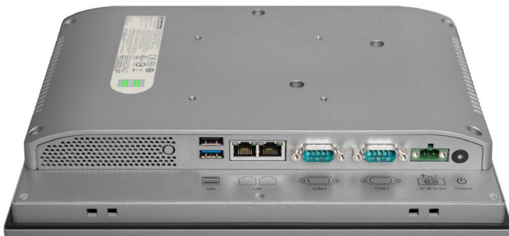
图 1.4: PPC-3100S-PBE 底部接口
