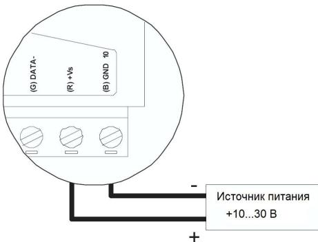
Для кабелей питания мы предлагаем использовать следующую стандартную цветовую маркировку проводников (как это обозначено на модулях):
